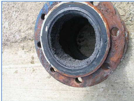
Abb. 3: Typische radioaktive Scale aus einer Geothermieanlage: Flansch (links), Plattenwärmetauscher (rechts).
