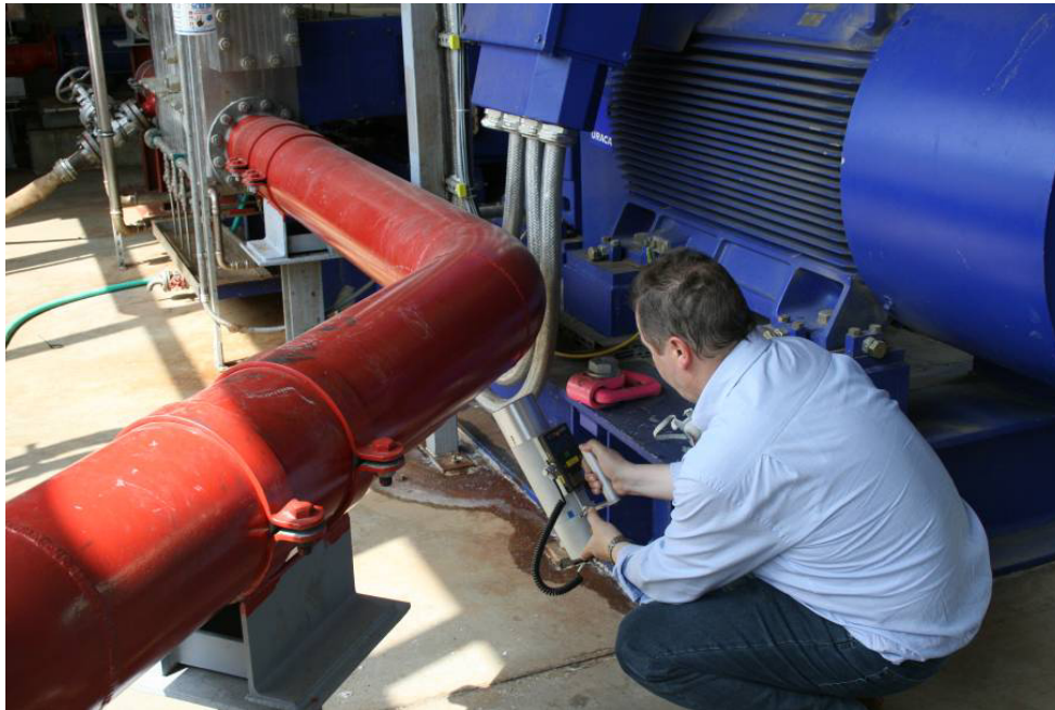
Abb. 8: Messung der Umgebungs-Äquivalentdosisleistung an der Außenseite eines Rohres zwischen Wärmetauscher und Injektionsbohrung (Abstand = 10 cm, Messgerät Automess Szintomat 6134 A)
